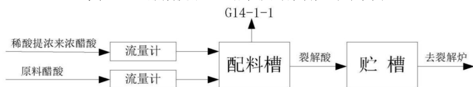
图 3.2-8 醋酸配料工艺流程及污染物产污环节图
